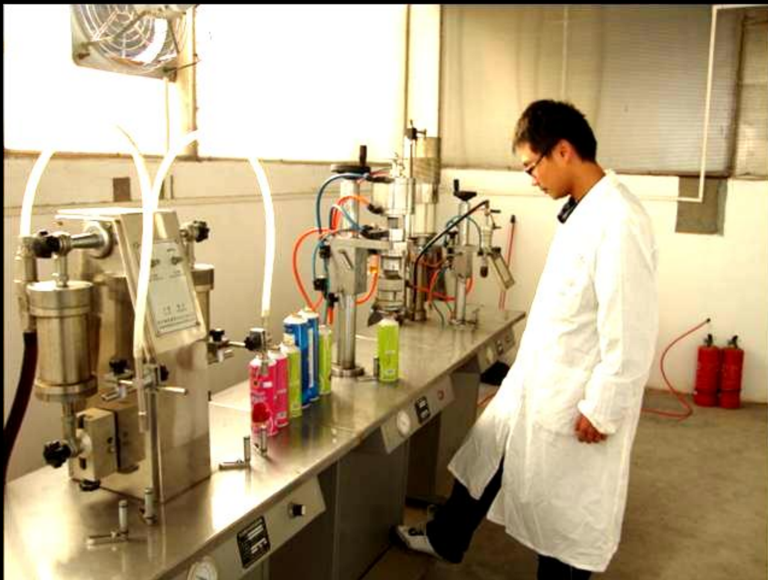
气雾剂加工中试生产线
